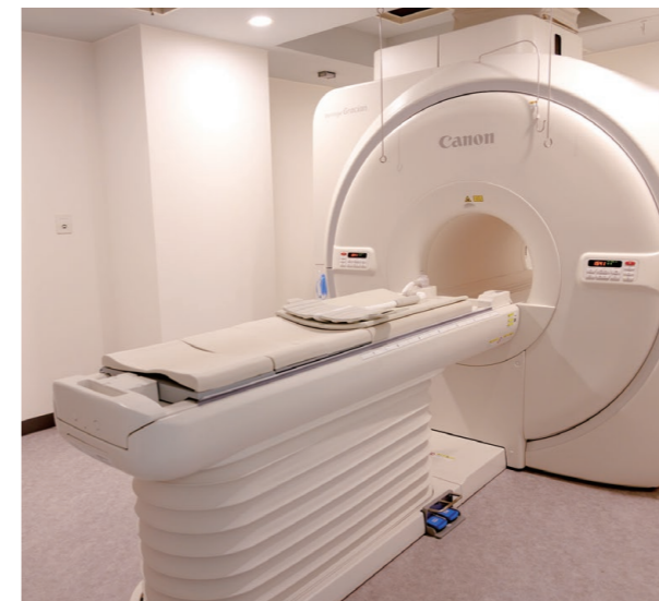
MRI検査機器 CANON Vantage Gracian 1.5テスラ
